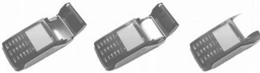
Тип и размер ролика: «термо 57x30», где 57 – ширина в мм, 30 – длина в метрах. Максимальный диаметр ролика – 38 мм.
